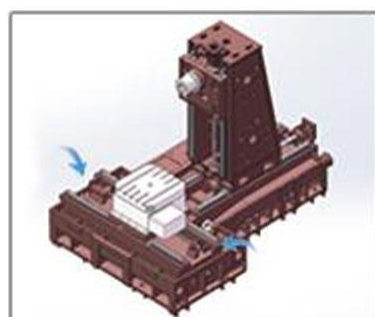
Спиральный экстрактор стружки легче чистить
