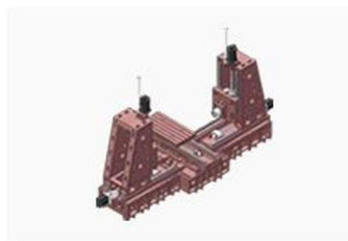
Горизонтальный многоцелевой станок с двойным ходом колонны
