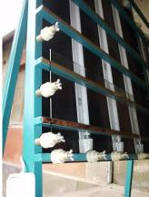
4.1. Чистое стекло устанавливается по предварительно выставленным упорам. Ролики эксцентрические, что позволяет предварительно устанавливать глубину установки дистанционной рамки.
