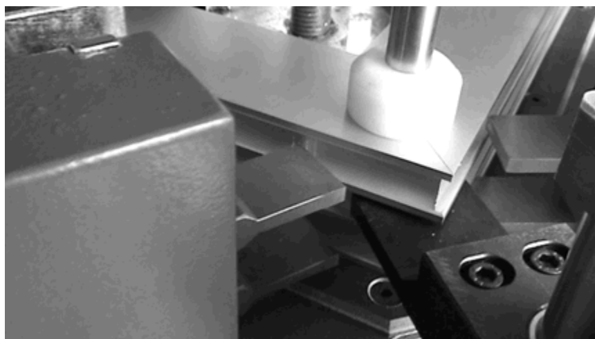
Рисунок 5.1-13 Точки соприкосновения пуансонов
