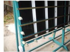
4.2. Следующим этапом является установка предварительно подготовленной рамки с нанесенным бутиловым шнуром
