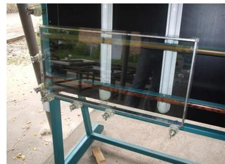
4.3. Заключаящим этапом сборки стеклопакета является установка второго стекла. Если стеклопакет двухкамерный, операция по установке дистанционной рамки повторяется, но в этом случае устанавливается еще одна промежуточная дистанционная шайба (изготовление шайб по доп.заказу).
